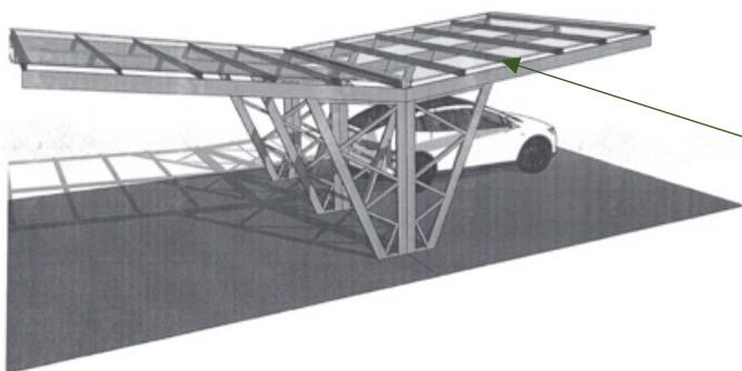
A.) **Carport Industrial Standard (CIS)** als Unterkonstruktion in Stahl oder Aluminium mit Standard-PV-Modulen und/oder auf Wunsch mit Glas-Glas-Modulen
